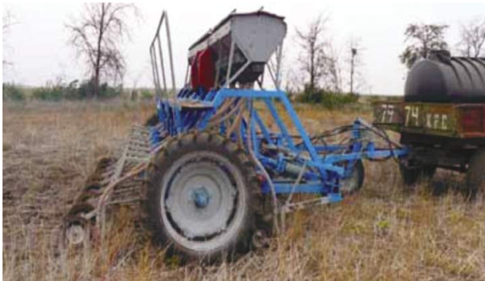
სურათი 27. ბალახების შეთესვა, სასუქებისა და ჰერბიციდების შეტანა თვითნაკეთი აგრეგატით, რომელიც ნიადაგს მოუხნავად თესავს
