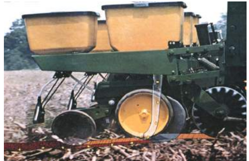
სურათი 26. თესლის ჩათესვის სქემა მოუხნავად ჩამთესი სისტემით
