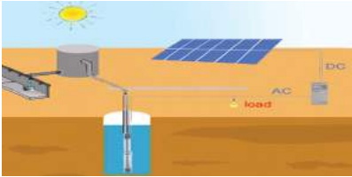
სურათი 14. მზის ფოტოელექტროსისტემით წყლის ამოტუმბვის სქემა
